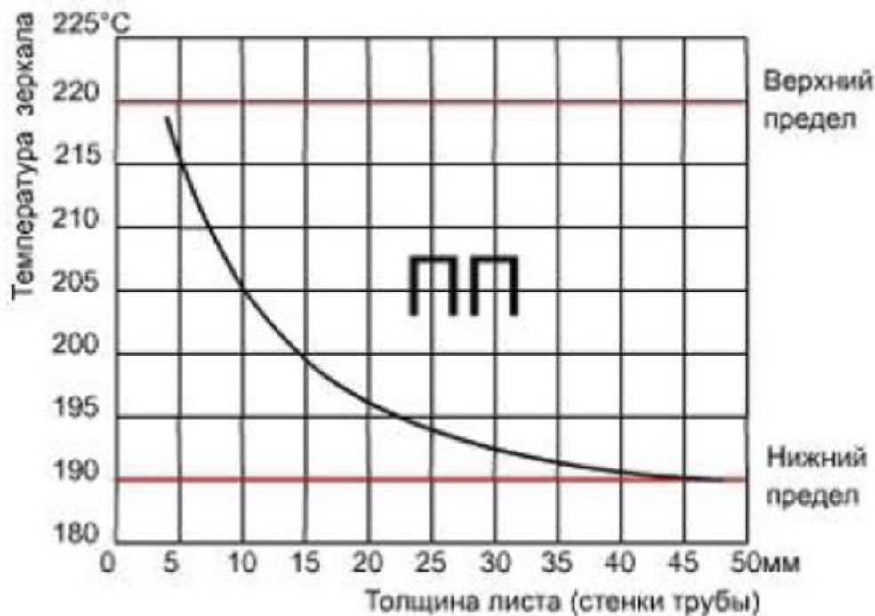
Рисунок №8 «Температура сварочного зеркала для ПП»
